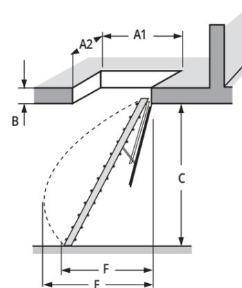
**Le misure di costruzione (pendenza scala 60°)**
